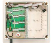
CONNECTING ON EXPANSION MODULE USING THE RIBBON CONNECTOR
